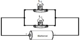
3. Sebuah sumber tegangan (baterai) disambung dengan dua lampu yang sama, yaitu L<sub>1</sub> dan L<sub>2</sub> seperti pada gambar. Jika lampu L<sub>2</sub> dicabut, maka arus listrik yang mengalir melalui lampu L<sub>1</sub> akan:
