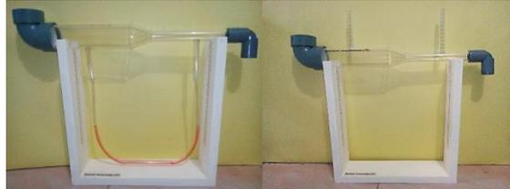
**GAMBAR 4.** Venturimeter dengan Manometer (VM) & Venturimeter Tanpa Manometer (VTM)
