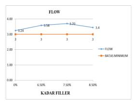
Gambar 2. Grafik *Flow* Pada Berbagai Kadar Aspal
