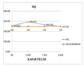
Gambar 3. Grafik *Marshall Quetiont* PadaBerbagai Kadar Aspal
