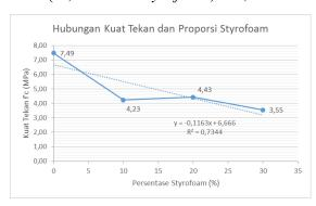
Gambar 2. Hubungan Kuat Tekan dan Proporsi *Styrofoam*
