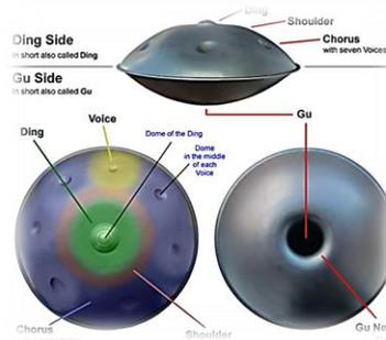
**Gambar 1.** Konstruksi *Handpan*
