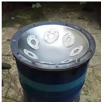
**Gambar 9.** Pemberian Cetakan untuk *Ding* dan *Dimple*
