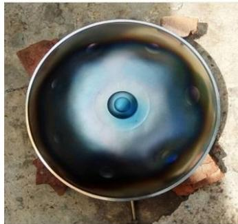
**Gambar 13.** Proses pengerasan
