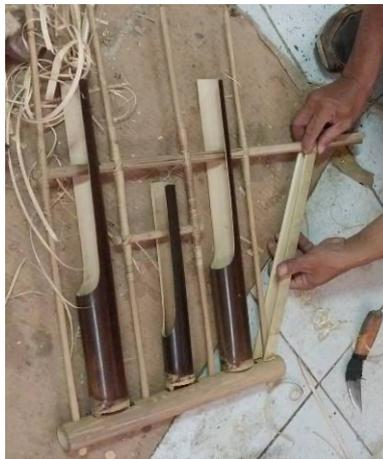
**Gambar 3.** Pembuatan/Pemasangan penyanggah segitiga
