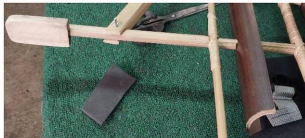
**Gambar 4.** Pemasangan tuts dengan spon hitam
