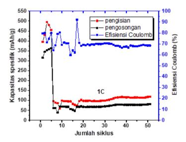
GAMBAR 3. Kurva stabilitas siklus dan efisiensi coulomb elektroda komposit AAEG/S pada laju muatan 1C
