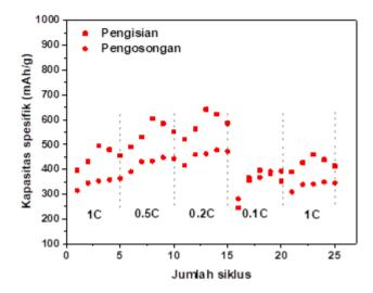
GAMBAR 2. Grafik stabilitas pengisian dan pengosongan baterai untuk variasi laju muatan 1C, 0,5C, 0,2C, dan 0,1C
