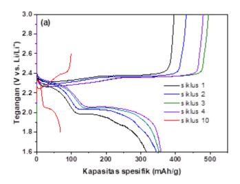
GAMBAR 1. Kurva pengisian dan pengosongan kapasitas untuk ketebalan lapisan 100 µm pada laju muatan 1,0 C
