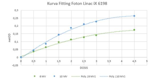
GAMBAR 3. Grafik plotting antara netOD dengan Dosis untuk energi foton 6 MV dan 10 MV.
