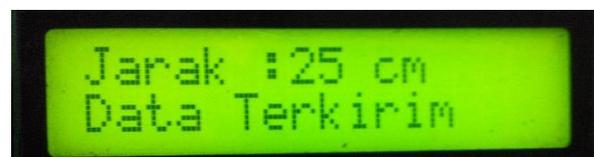
Gambar 8. Hasil pembacaan ketinggian permukaan air pada layar monitor LCD 16x2.
