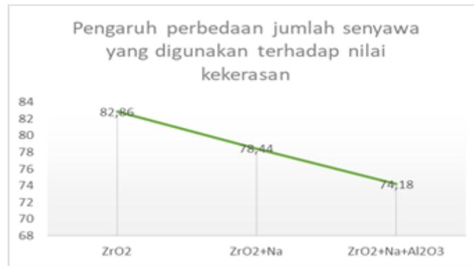
**GAMBAR 4.** Hubungan perbedaan campuran senyawa pelapis yang digunakan terhadap nilai kekerasan lapisan oksida yang terbentuk
