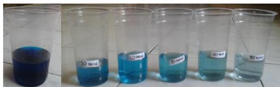
Gambar 3. Hasil adsorpsi karbon aktif pada larutan *methylene blue*
