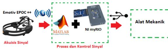
**Gambar 3.** Perancangan Sistem Hardware
