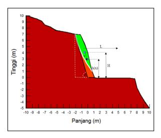
Gambar 9. Parameter geometri yang digunakan dalam perhitungan kecepatan dan run-out pusat massa tanah bahan longsoran.
