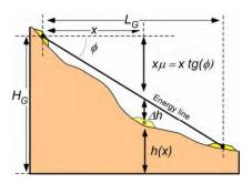
Gambar 3. Ilustrasi pergerakan pusat massa tanah (Jaboyedoff et al., 2008) [7].
