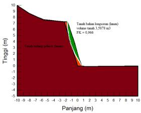
Gambar 7. Hasil perhitungan stabilitas lereng lbg.
