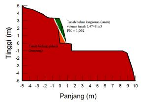
Gambar 6. Hasil perhitungan stabilitas lereng cjb3.
