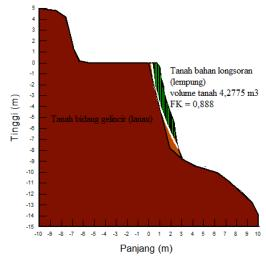
Gambar 5. Hasil perhitungan stabilitas lereng cjb2.
