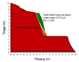
Gambar 4. Hasil perhitungan stabilitas lereng cjb1.
