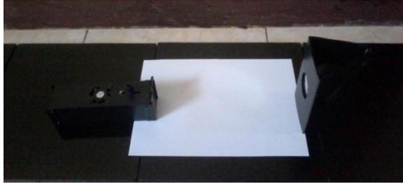
Gambar 6. Contoh susunan alat praktikum untuk menentukan fokus dan jari-jari kelengkungan cermin lengkung
