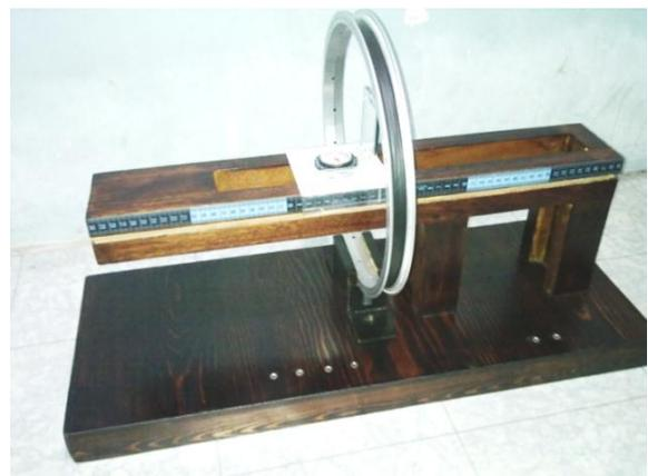
**Gambar 3.** Alat praktikum medan magnet pada loop kawat berarus dengan muatan uji disepanjang sumbu loop
