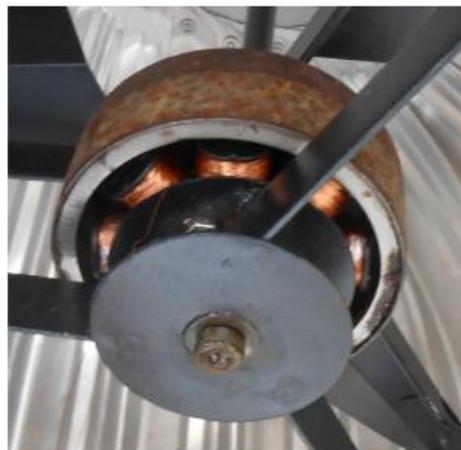
Foto dinamo bekas yang sudah dimodifikasi dan dipasang pada ventilator
