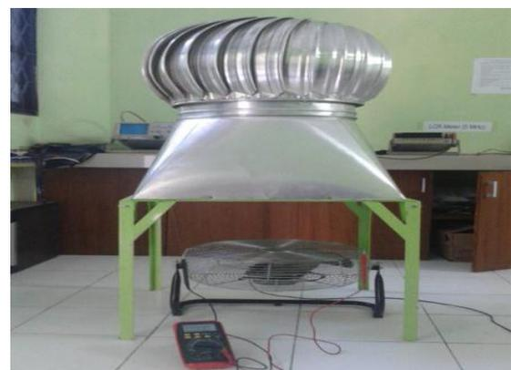
Gambar 3. Pengukuran arus/tegangan output dari turbin ventilator
