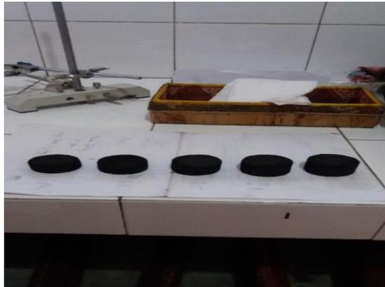
**GAMBAR 1.** Sampel briket dari kiri ke kanan variasi tekanan 5ton, 4 ton, 3 ton, 2 ton, dan 1ton.
