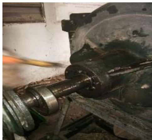
Gambar 7. Perbaikan Poros Engkol
