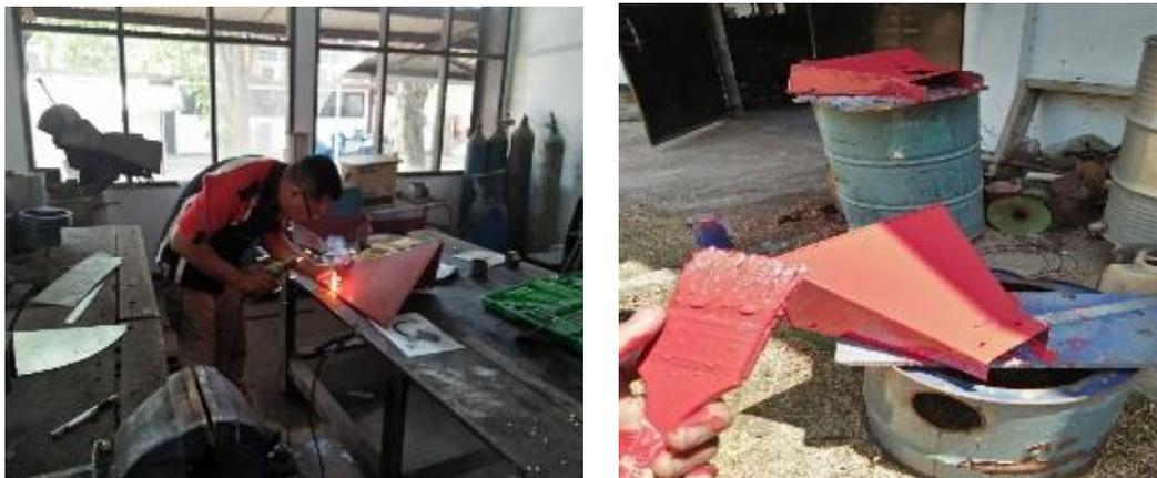
Gambar 6. Proses Perbaikan *Hopper*
