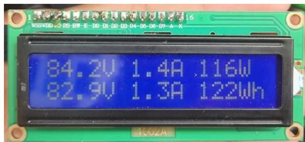
Gambar 9. Tampilan Pengukuran pada LCD
