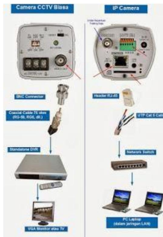
Gambar 2. Perbandingan blok diagram CCTV dan IP camera
