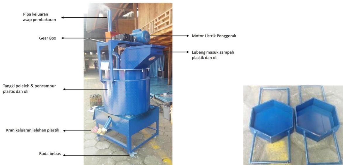
Gambar 5. Mesin Insinerator Sampah Plastik dan Cetakan Paving Hexagonal
