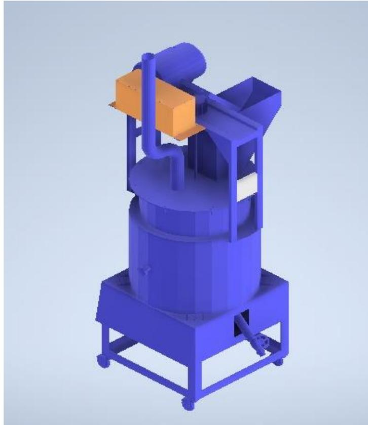
Gambar 4. Rancangan Mesin Insinerator
