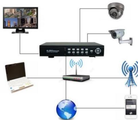
Gambar 1. Sistem Monitoring CCTV Menggunakan PC dan Smartphone
