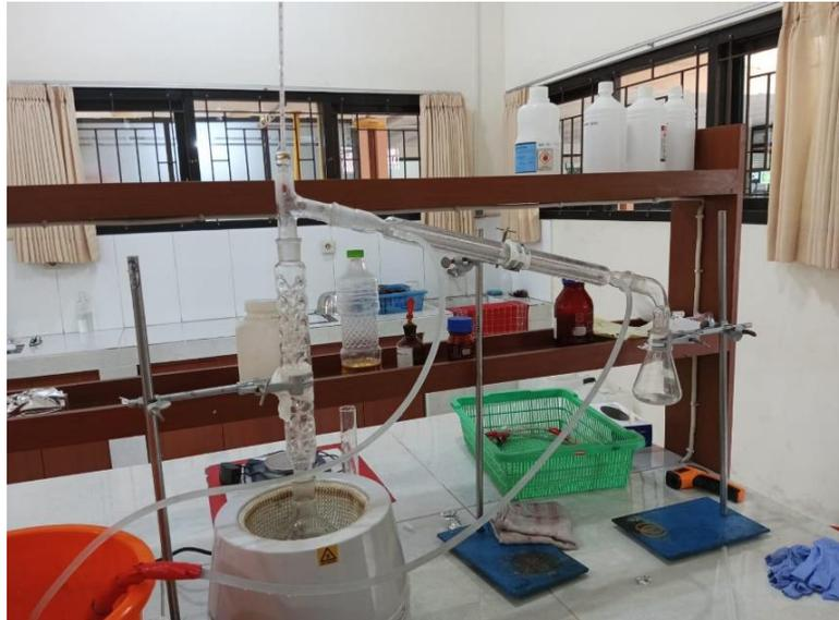
Gambar 1. Rangkaian Uji Coba Peralatan Pemisahan Minyak.
