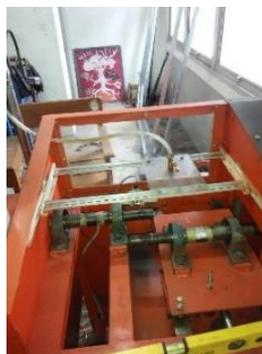
**GAMBAR 2.** Alat Pengujian Keausan
