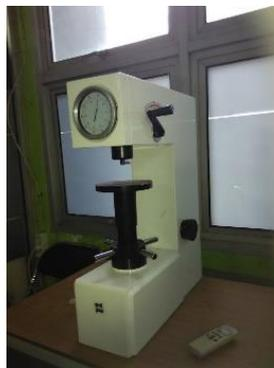
**GAMBAR 1.** Alat Pengujian Kekerasan *Brinell*
